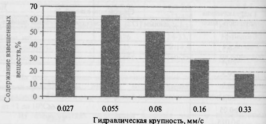
Рис. 3.2. Дисперсный состав сточных вод ДВП.
