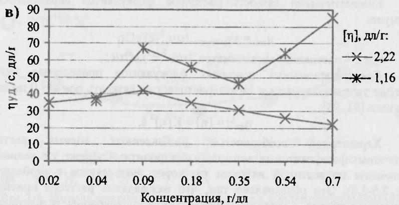
Рис. 2.5. Зависимость  $\eta_{уд}/с$  водных растворов флокулянтов от их концентрации: а) ВПК 101, б) ППС, в) ППС.
