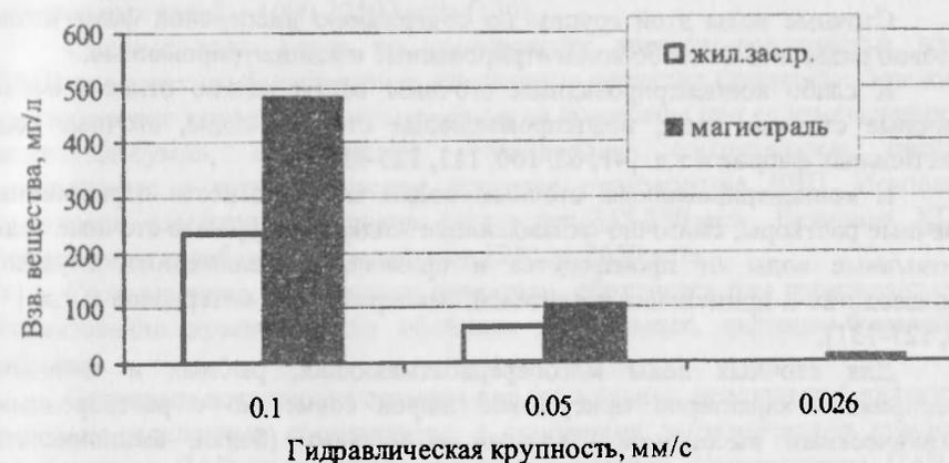
Рис. 3.1. Дисперсный состав талых вод после отстаивания.
