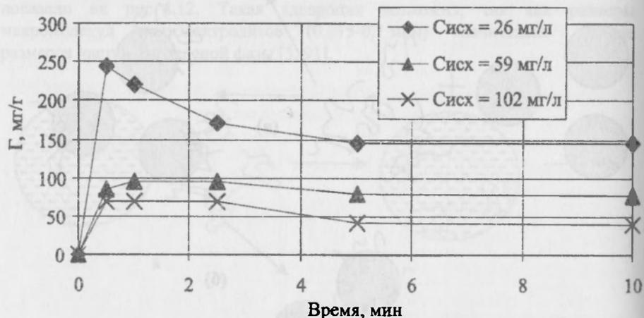
Рис. 4.14. Кинетика адсорбции ППС при флокуляции модельной нефтесодержащей сточной воды.
