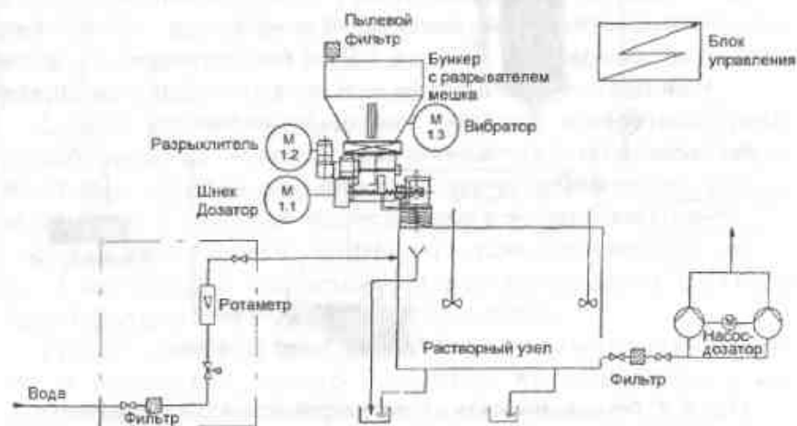
Рис. 9.3. Гидравлическая схема узла приготовления раствора коагулянта
