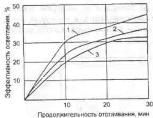
Рис. 6.27. Влияние процесса перемешивания на эффективность осветления воды при отстаивании
