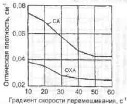
Рис. 7.13. Влияние интенсивности перемешивания воды (р. Волги) с коагулянтами СА и ОХА ( D_k = 10 мг/л) на качество осветленной воды при отстаивании
