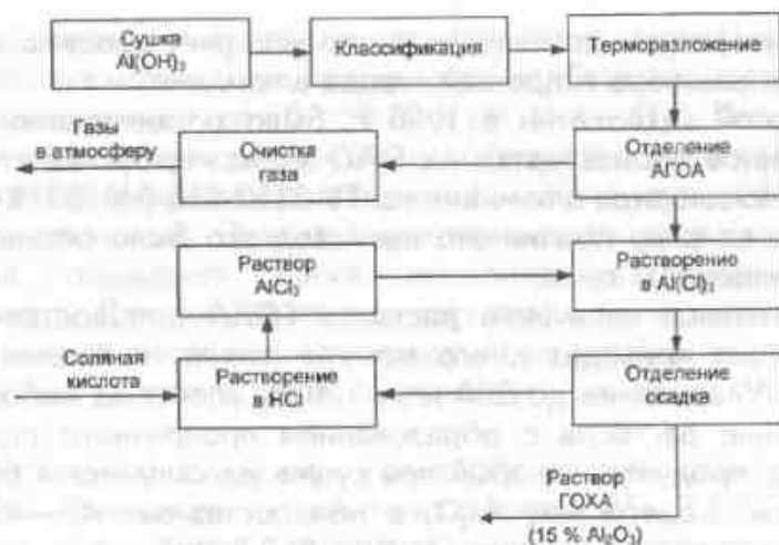
Рис. 4.18. Получение гидрохлорида алюминия из активированного гидроксида алюминия
