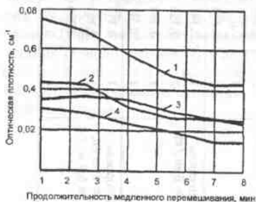
Рис. 6.17. Влияние продолжительности медленного перемешивания воды (р. Волги) с коагулянтами СА и ОХА на процесс ее осветления и отстаивания: 1 — СА-10; 2 — ОХА-10; 3 — СА-12; 4 — ОХА-12
