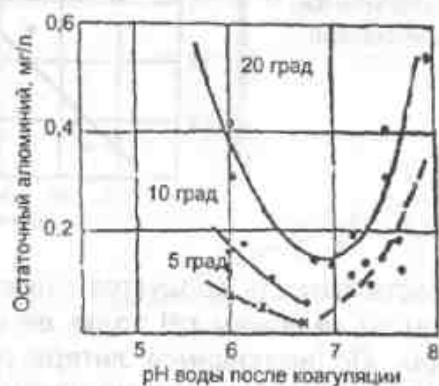
Рис. 6.9. Зависимость концентрации растворенного алюминия от рН воды после коагуляции
