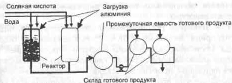
Рис. 4.16. Технологическая схема производства оксихлорида алюминия
