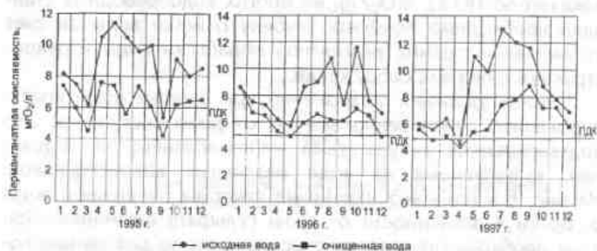
Рис. 6.5. Изменение показателя перманганатной окисляемости в исходной и очищенной воде на станции № 6 за период 1995—1997 гг.
