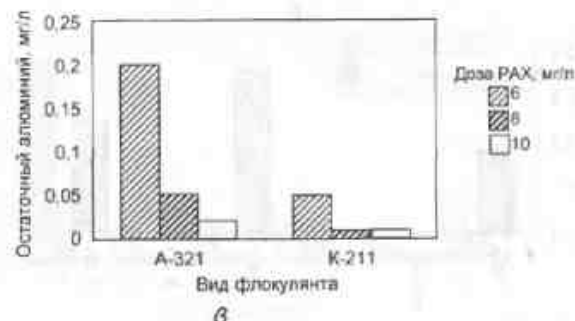
Рис. 7.25. Изменение качества очищенной воды Воткинского водохранилища в зависимости от дозы PAX и вида флокулянта (лето 1997 г.);
