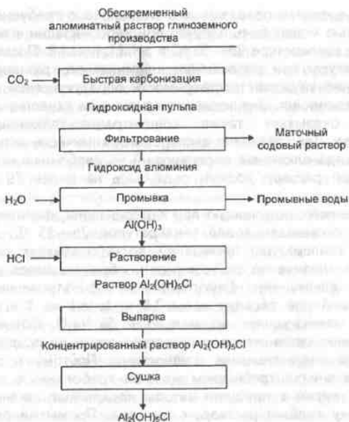
Рис. 4.17. Получение гидрооксихлорида алюминия
