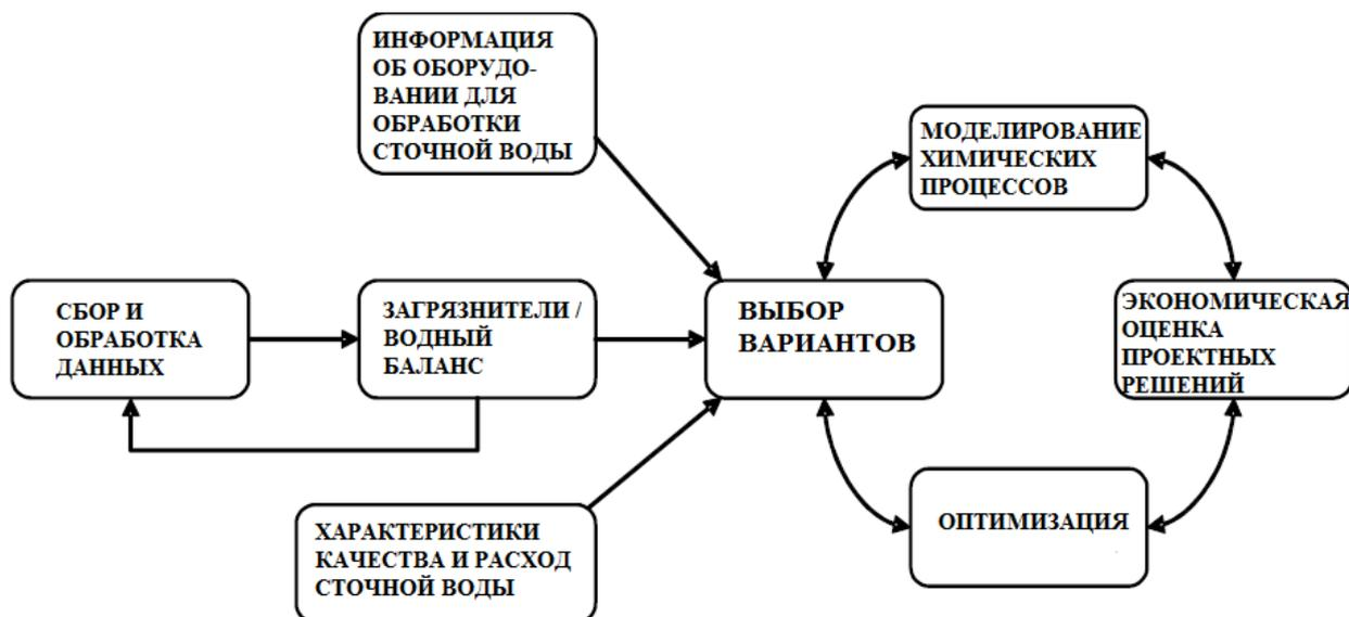
Рисунок 2.2 — Блок-схема процедуры оптимизации системы водоиспользования
