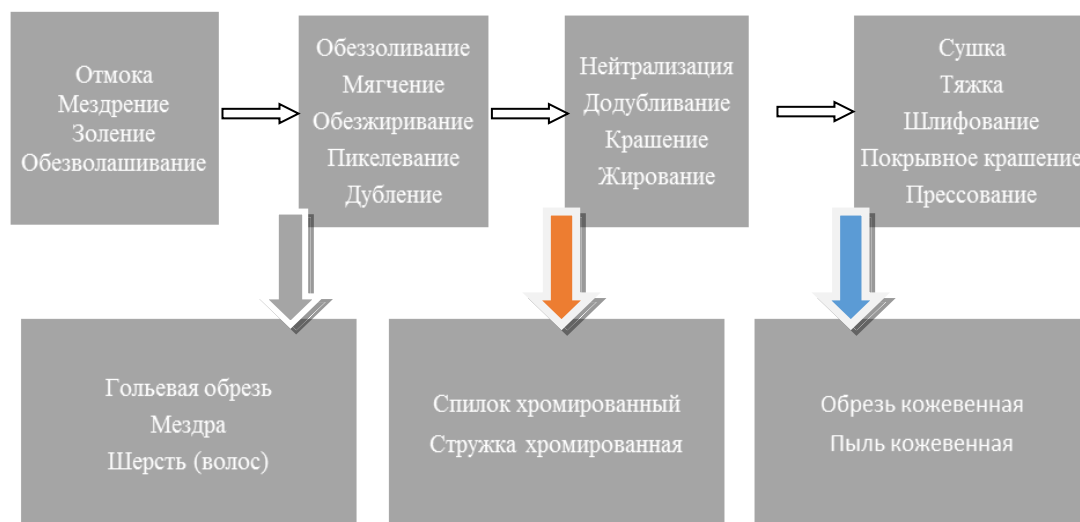
Рисунок 2.4 — Схема образования побочных продуктов в технологическом процессе
