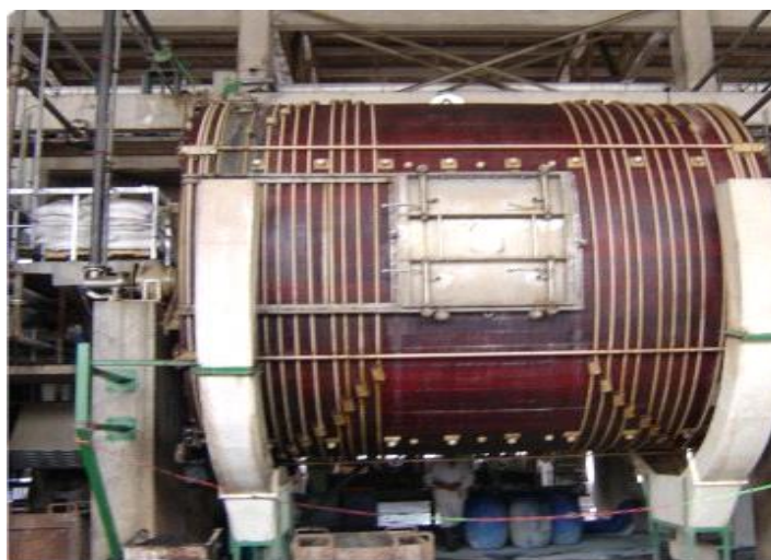
Рисунок 2.2 — Барабан для отмочно-зольных процессов
