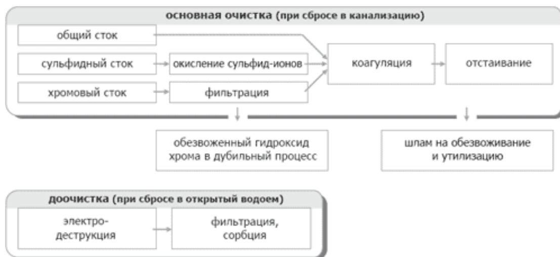
Рисунок 4.3 — Схема физико-химической обработки стоков
