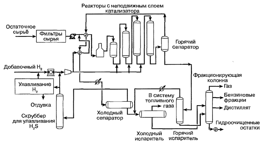
Рисунок 7.11 – Технологическая схема процесса RCD Unionfining
